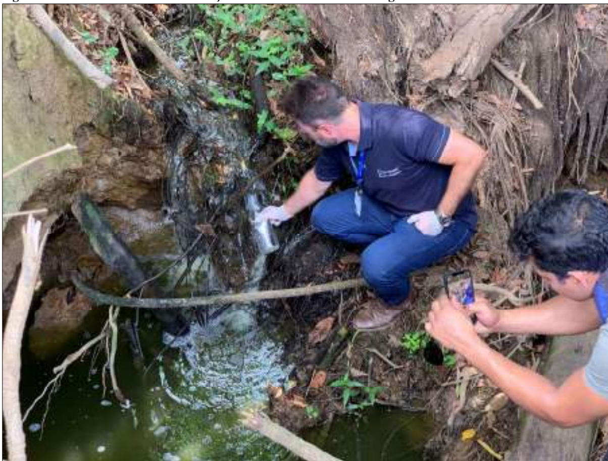
Figura 72 – Coleta no Ponto 02 – Lançamento do Tratamento de Esgoto - CAEMA.
